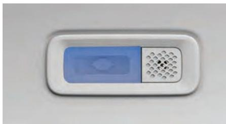
Нажмите кнопку заднего плафона на соответствующей стороне, чтобы включить или выключить освещение.
