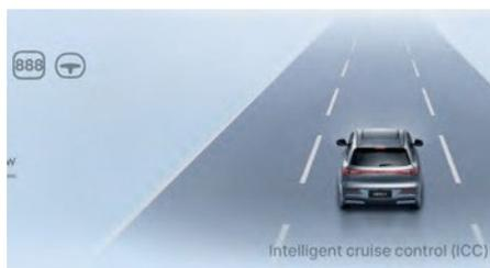
После включения интеллектуального круиз-контроля (ICC) на мультимедийном дисплее его можно активировать нажатием кнопки ОК, расположенной с левой стороны рулевого колеса. При этом на комбинации приборов загорятся серым цветом индикаторы продольного и поперечного управления системой круиз-контроля.
