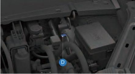
5. Подсоедините другой конец черного отрицательного (–) кабеля к точке массы (D) на кузове автомобиля без питания, как показано выше. Проверьте и убедитесь, что зажимы пусковых проводов и клеммы батарей прочно закреплены, чтобы избежать искрения при попытке запуска;
