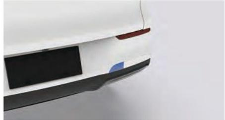
2. Возьмите плоскую отвертку, обернутую тканью, и подденьте правую заглушку монтажного отверстия заднего бампера;
