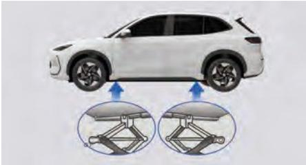
6. Поворачивайте рукоятку домкрата по часовой стрелке, как показано на рисунке. Поднимите автомобиль на достаточную высоту для установки запасного колеса.
