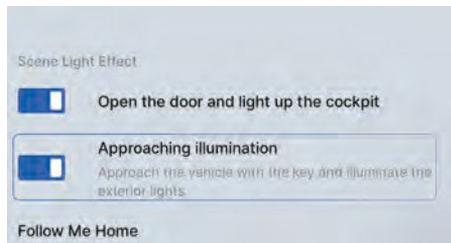
На мультимедийном дисплее выберите последовательно: «Настройки автомобиля → Освещение → Сценарии и световые эффекты», затем включите или выключите функцию освещения при приближении. Если функция активирована, при приближении к автомобилю с действующим смарт-ключом включается наружное освещение.
