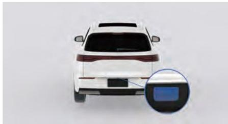
Если смарт-ключ не может обнаружить или разблокировать автомобиль после длительного периода стоянки, необходимо нажать и удерживать внешнюю кнопку открытия багажника, чтобы активировать питание низковольтной аккумуляторной батареи. После отпирания автомобиля откройте дверь водителя, включите высоковольтное питание, после этого автомобиль можно использовать в обычном режиме.
