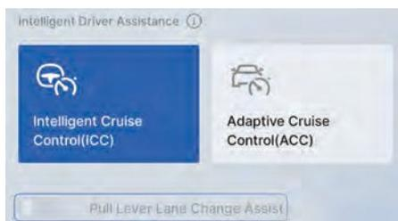
На мультимедийном дисплее при включенной функции удержания по центру полосы выберите последовательно: «Настройки автомобиля → Система помощи водителю → Интеллектуальная система помощи водителю», затем в интерфейсе выберите пункт «Автоматическая смена полосы».
