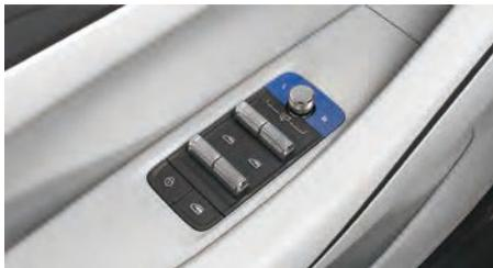
Одновременно нажмите кнопки выбора зеркал L и R, и зеркала заднего вида автоматически сложатся. Нажмите их снова, и зеркала автоматически разложатся.
