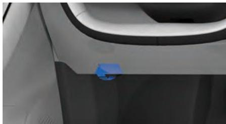
1. Потяните за рукоятку открывания капота, расположенную в нижней левой части панели приборов со стороны водителя.
