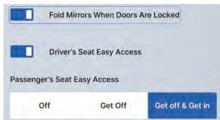
На мультимедийном дисплее выберите: «Настройки автомобиля → Управление автомобилем → Предпочтения автомобиля», затем включите или выключите функцию складывания зеркал при запирании автомобиля.
