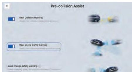
Эта функция активируется при медленном движении автомобиля или при движении задним ходом, когда селектор находится в положении заднего хода (R) или нейтрالي (N). При обнаружении возможного столкновения система предупреждает водителя звуком, световыми индикаторами и сообщением на экране, а при необходимости выполняет автоматическое торможение, чтобы предотвратить столкновение с поперечно движущимся транспортным средством при выезде с парковочного места.
