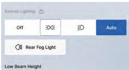
На мультимедийном дисплее выберите: «Настройки автомобиля → Освещение → Наружные огни», затем нажмите кнопку включения габаритных огней. После появления всплывающего окна переместите ползунок для подтверждения и включения габаритов.
