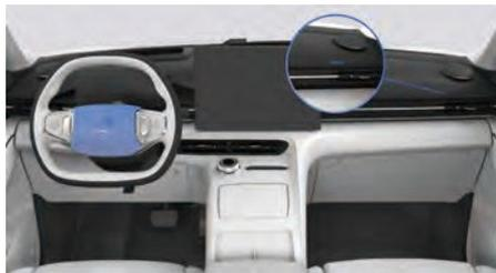
Одна подушка безопасности установлена в центре рулевого колеса, а другая в панели приборов над перчаточным ящиком. Обе подушки имеют маркировку «AIRBAG».
