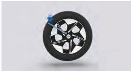
3. Наденьте баллонный ключ на гайку колесного крепления и поверните ключ против часовой стрелки; ослабьте все гайки примерно на один оборот, но не снимайте их.
