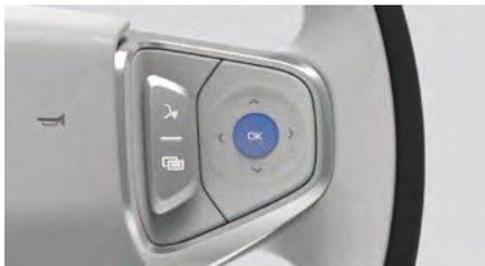
В интерфейсе отображения информации бортового компьютера нажмите и удерживайте кнопку ОК, чтобы сбросить данные.
