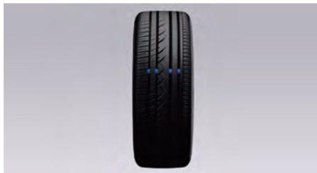
Индикатор износа протектора становится заметен, когда глубина рисунка протектора уменьшается до 1,6 мм или меньше. После достижения предельного износа шины необходимо заменить как можно скорее. Если наблюдается неравномерный износ или при движении ощущается постоянная вибрация, обратитесь в сервисный центр Geely для проверки. При установке новых шин обязательно выполните их динамическую балансировку.
