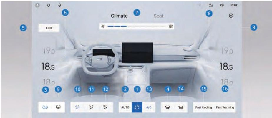
1. Кнопка включения/выключения кондиционера
