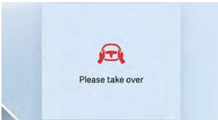
Если и после второго предупреждения водитель продолжает не удерживать руль, система интеллектуального круиз-контроля включает аварийную сигнализацию, и замедлит автомобиль до полной остановки в рамках занимаемой полосы движения и отключает функцию. После этого поперечное и продольное управление не выполняются до повторного включения функции водителем.
