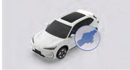
Датчик используется для управления температурой внутри салона, а также для включения/выключения функции автоматического стеклоочистителя и автоматического света.
