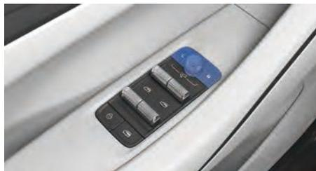
Переключатель регулировки наружных зеркал расположен на панели облицовки двери со стороны водителя.
