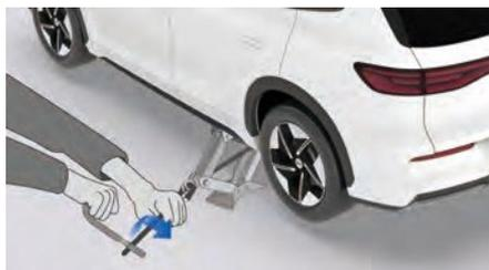
4. Установка опорной площадки домкрата. Отрегулируйте домкрат на подходящую высоту, как показано на рисунке, и затем установите домкрат под точку подъема.
