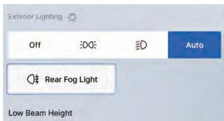
При включенном ближнем свете выберите на мультимедийном дисплее: «Настройки автомобиля → Освещение → Наружные огни», затем нажмите кнопку включения задней противотуманной фары.
