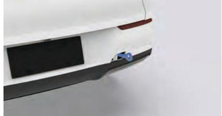
3. Вкрутите буксировочную проушину в монтажное отверстие и затяните инструментом до упора, убедившись, в ее надежной фиксации.
