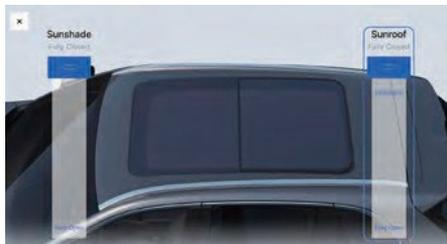
На мультимедийном дисплее выберите по порядку: «Настройки автомобиля → Быстрый доступ», затем нажмите значок люка, чтобы открыть интерфейс регулировки люка и солнцезащитной шторки.
