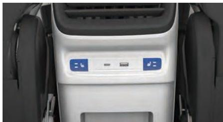
Функцию подогрева задних сидений можно включить с помощью соответствующего переключателя. При включенном питании автомобиля, нажмите переключатель с нужной стороны, чтобы активировать подогрев заднего сиденья. При первом нажатии подогрев работает на 1-й ступени. Нажмите переключатель второй раз, чтобы перейти на 2-ю ступень, а при третьем нажатии подогрев отключается.
