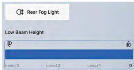
Отрегулируйте высоту светового пучка фар в зависимости от количества пассажиров и нагрузки автомобиля.
