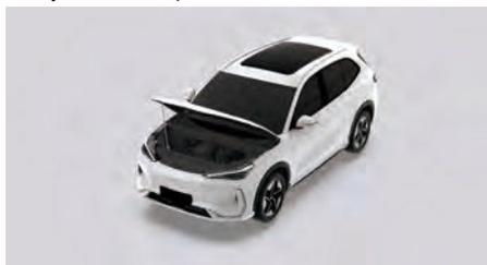
3. Поднимите капот и зафиксируйте его при помощи упорного стержня капота.
