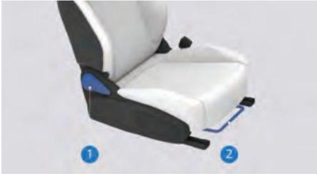
1. Рычаг регулировки угла наклона спинки. Потяните рычаг регулировки угла наклона спинки, чтобы разблокировать спинку. Осторожно надавите на спинку или медленно отклоните ее вперед или назад до требуемого положения. Отпустите рычаг, чтобы зафиксировать спинку.
