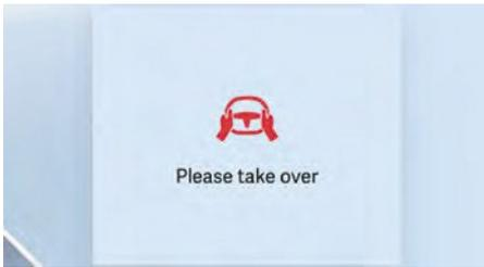
Если функция обнаруживает, что через определённое время после срабатывания первого предупреждения водитель по-прежнему не держит руки на рулевом колесе, срабатывает предупреждение второго уровня.
