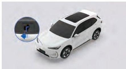
2. Нажмите на рычаг предохранительного крючка замка капота в направлении, указанном стрелкой.
