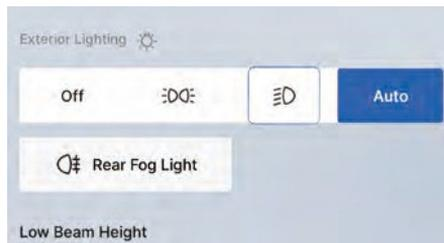
На мультимедийном дисплее выберите: «Настройки автомобиля → Освещение → Наружные огни», затем нажмите кнопку включения ближнего света. После появления всплывающего окна переместите ползунок для подтверждения и включения ближнего света.
