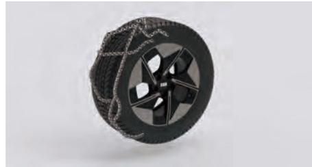
Принимайте решение о необходимости установки цепей противоскольжения в зависимости от реальных дорожных условий. При использовании цепей противоскольжения старайтесь не загружать автомобиль полностью. Кроме того, двигайтесь с низкой скоростью, соблюдая осторожность.
