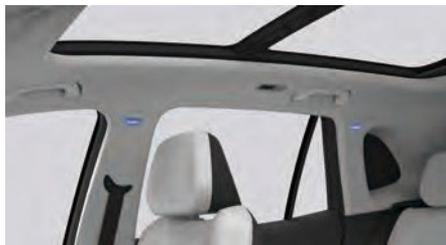
Боковые шторки установлены над боковыми стойками с обеих сторон автомобиля и имеют маркировку «AIRBAG».
