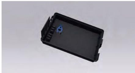
2. Захватите предохранитель с помощью съемника и извлеките предохранитель. Проверьте, не перегорел ли металлический провод;
