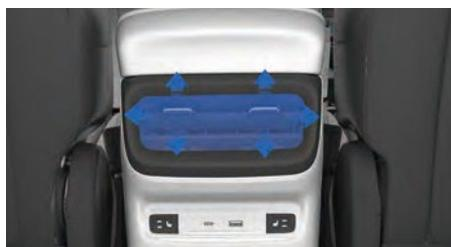
Отрегулируйте направление потока воздуха, перемещая решетку дефлектора вверх, вниз, влево и вправо. Также с помощью заслонок дефлектора можно закрыть подачу воздуха через дефлектор.
