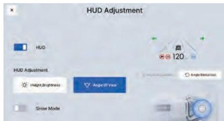
На мультимедийном дисплее выберите: «Настройки автомобиля → Управление автомобилем → Предпочтения → Регулировка проекционного дисплея», чтобы выполнить настройку системы проекционного дисплея.
