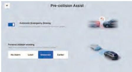
Система ассистента предотвращения столкновений (CMSF) является элементом активной безопасности и включается автоматически при каждом цикле запуска автомобиля.
