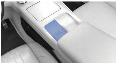
Устройство беспроводной зарядки для мобильных телефонов расположено на вспомогательной панели приборов.
