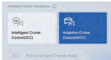
На мультимедийном дисплее выберите последовательно: «Настройки автомобиля → Система помощи водителю → Интеллектуальная система помощи водителю», затем выберите функцию адаптивного круиз-контроля (ACC).
