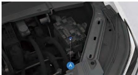
2. Подсоедините один конец красного (положительного) кабеля к положительной (+) точке для пуска в блоке предохранителей переднего моторного отсека на автомобиле с разряженной батареей (A);
