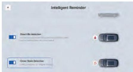
Для включения или выключения функции мониторинга состояния водителя выберите последовательно на мультимедийном дисплее: «Настройки автомобиля → Система помощи водителю → Настройки безопасности → Интеллектуальные уведомления».
