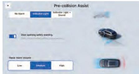
На мультимедийном дисплее выберите: «Настройки автомобиля → Система помощи водителю → Настройки безопасности → Предупреждение о столкновении», затем в этом разделе выберите уровень громкости звукового сигнала парковочных датчиков. Доступны три уровня громкости: низкий, средний и высокий.
