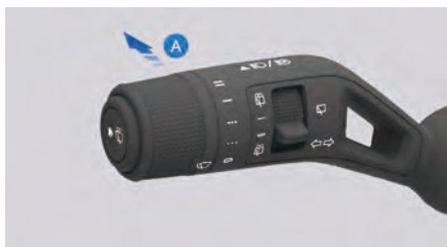
Если внешний свет установлен в положение Авто в настройках мультимедийного дисплея, поверните комбинированный переключатель света в направлении А один раз в темное время суток и включится дальний свет; поверните его второй раз и активируется система автоматического управления дальним светом (АНВС). В ночное время, когда передние фары автоматически включаются, система АНВС также активируется автоматически.
