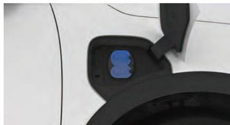
2. Нажмите на левую часть крышки зарядного порта, чтобы она открылась, и снимите защитную крышку зарядного разъема;
