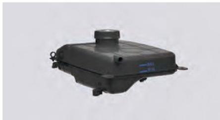
Перед проверкой уровня охлаждающей жидкости убедитесь, что автомобиль припаркован на ровной поверхности. Проверьте, чтобы уровень охлаждающей жидкости в расширительном бачке находился между отметками MAX и MIN.
