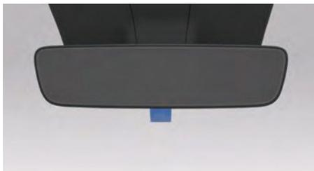
Нажмите на нижнюю ручку внутреннего зеркала заднего вида, чтобы изменить угол обзора и переместить его в положение затемнения. Потяните ручку назад, чтобы вернуть внутреннее зеркало заднего вида в обычное положение без затемнения.
