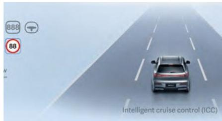
Когда автомобиль въезжает в зону действия дорожного знака ограничения скорости, на комбинации приборов отображается соответствующий знак.
