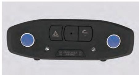
Коснитесь переднего плафона освещения, чтобы включить или выключить свет.
