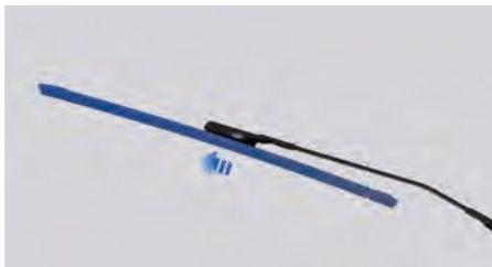
3. Нажмите на фиксатор щетки и потяните щетку в направлении, указанном стрелкой, чтобы отсоединить ее от рычага стеклоочистителя.
