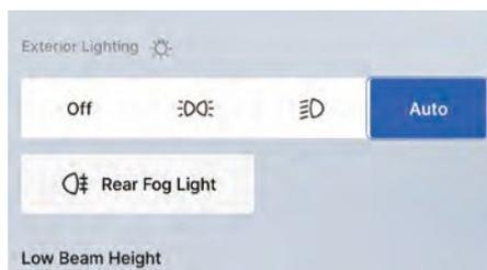
На мультимедийном дисплее выберите: «Настройки автомобиля → Освещение → Наружные огни», затем нажмите кнопку автоматического освещения. После появления всплывающего окна переместите ползунок для подтверждения и активации функции. После включения функции автоматического освещения система будет автоматически управлять включением и выключением фар в зависимости от уровня внешнего
