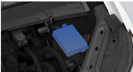
Крышку блока предохранителей можно снять, открыв крышку переднего отсека и освободив фиксатор крышки блока предохранителей. Информация о предохранителях для данного автомобиля расположена на внутренней стороне крышки блока предохранителей и доступна после ее открытия.
