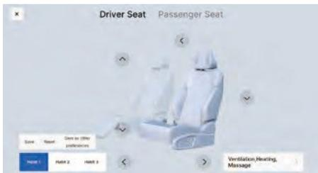
1. На мультимедийном дисплее последовательно выберите: «Настройки автомобиля → Быстрый доступ → Регулировка сиденья», чтобы открыть интерфейс регулировки сиденья.
