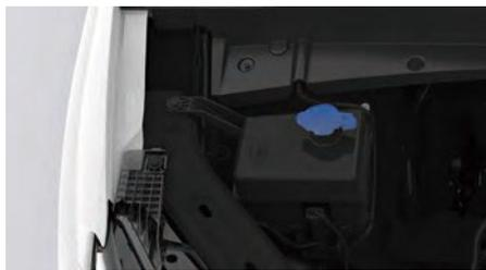
Откройте крышку заливной горловины с символом стеклоомывателя и долейте омывающую жидкость в бачок.
