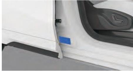
На автомобиле размещены информационные таблички с данными о давлении в шинах. Табличка расположена снаружи под средней стойкой с левой или правой стороны и указывает рекомендуемое давление для шин.
