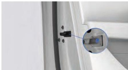
1. Вставьте механический ключ в черный поворотный фиксатор замка двери и поверните.
