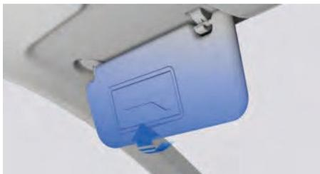
Опустите солнцезащитный козырек или снимите его с держателя и поверните в сторону двери, чтобы защититься от ослепляющего света.
