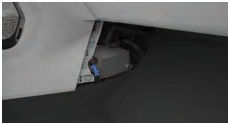
3. Откройте передние двери и отсоедините отрицательную клемму низковольтной аккумуляторной батареи, расположенную под нижней панелью приборов.
