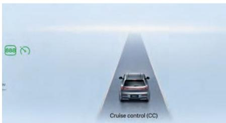
Круиз-контроль (СС) можно включить, нажав кнопку ОК на левой стороне рулевого колеса. После включения система переходит в режим ожидания, а индикатор состояния круиз-контроля на комбинации приборов загорается белым цветом.
