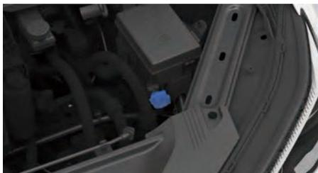
2. Отключите низковольтный ремонтный выключатель в переднем моторном отсеке.
