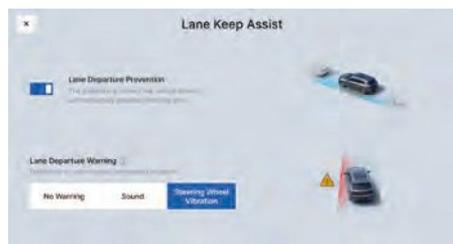
На мультимедийном дисплее выберите: «Настройки автомобиля → Система помощи водителю → Настройки безопасности → Ассистент движения по полосе», затем включите или выключите функции ассистента движения по
