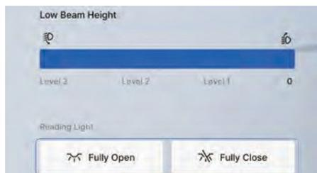
На мультимедийном дисплее выберите последовательно: «Настройки автомобиля → Освещение → Индивидуальное освещение», затем включите или выключите все плафоны в этом интерфейсе.
