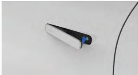
Нажмите на левую часть наружной ручки двери водителя, чтобы правая сторона слегка приподнялась, затем удерживая правую часть ручки, вставьте механический ключ в замок двери водителя. Поверните ключ по часовой стрелке – дверь запирается. Поверните ключ против часовой стрелки – дверь отпирается.
