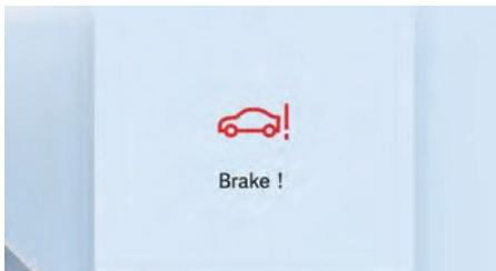
Позволяет избежать или смягчить столкновение с другими транспортными средствами. Основной сценарий применения: риск прямого столкновения с впереди идущим автомобилем. При обнаружении опасности система предупреждает водителя звуком, изображением на комбинации приборов и легким торможением, побуждая своевременно принять меры.
